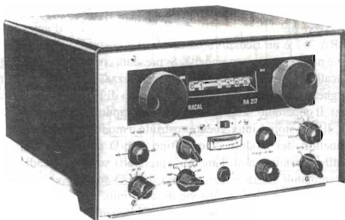
Foto 1 - L'RA.217, il primo ricevitore transistorizzato prodotto dalla Racal.
