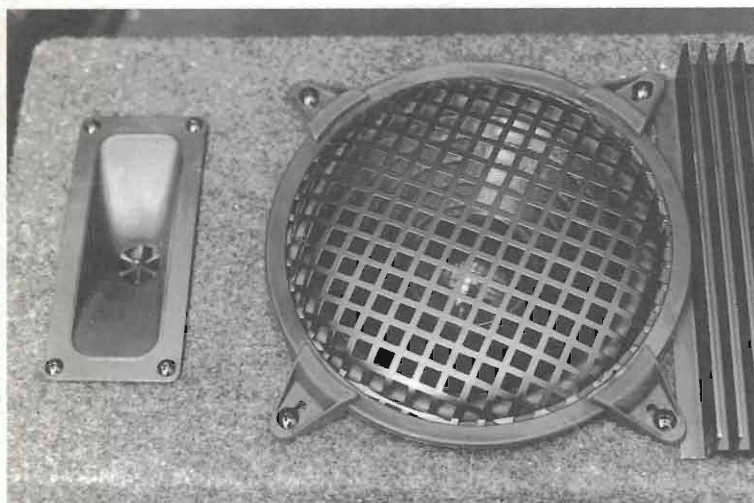
Foto 7 - Equipaggiamento acustico relativo ad un canale: Tweeter piezo tromba e Woofer larga banda ø23 cm.
