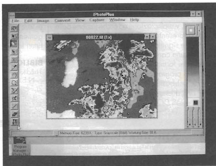
figura 4 - Telefoto I.R. (800 nanomt.) trasmessa da un satellite NOAA il 22/06/97 alle ore 14.02. Questa immagine (riprodotta quale esempio di versatilità del file format TIF) è stata in un primo tempo memorizzata in GIF usando il software "JvFax 6.0" e "riarchiviata" in TIF. Visualizzata successivamente impiegando il programma "iPhoto Plus" è stata modificata "invertendola" e variandone il contrasto e la luminosità per poter ottenere una foto più facilmente riproducibile.
